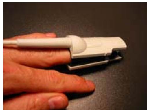
Je mehr Blut sich im Untersuchungsabschnitt befindet, desto mehr Licht wird absorbiert und vom fotografischen Sensor nicht erfasst. Die Auswertung der pro Herzschlag ausgeworfenen Blutmenge und dem peripheren Widerstand (Gefäßstatus) ermöglicht die Erfassung der **Herzrate**. (Schläge pro Minute).
